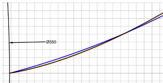
Obr. 1: Porovnání evolvent (kresleno v 10 mm čtvercové mřížce)
